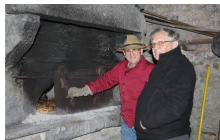
Le four doit être à bonne température, la voute et la sole sont blanchies par la combustion des fagots. Les braises sont retirées à l'aide d'un racloir. On peut placer au bout d'une pique une feuille de papier, son changement de couleur indique si le four est à la bonne température.
