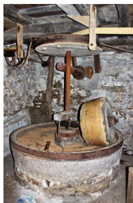
Le moulin à huile écrase les cerneaux jusqu'à obtention d'une pâte. Après avoir été chauffée, cette pâte est installée dans le pressoir à manivelle et bientôt l'huile s'écoule.
