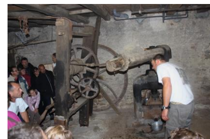
Le moulin à huile écrase les cerneaux jusqu'à obtention d'une pâte. Après avoir été chauffée, cette pâte est installée dans le pressoir à manivelle et bientôt l'huile s'écoule.
